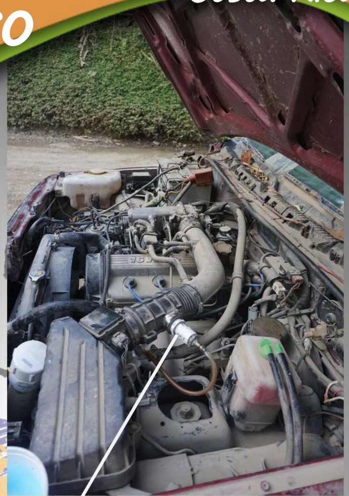
Hydrogène rentrant par l'admission d'air du moteur
